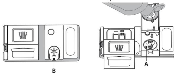
1. Откройте дозатор **B**, нажав и потянув вверх язычок крышки.
