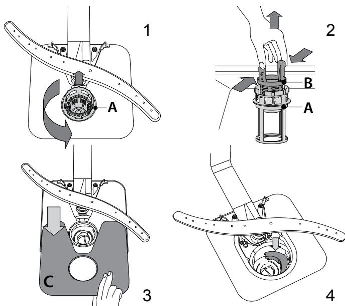
После чистки фильтров установите на место и надежно закрепите фильтрующий узел: это важно для исправной работы посудомоечной машины.
