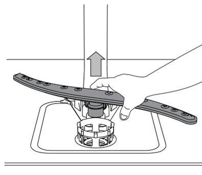
Нижнюю лопасть можно снять, потянув ее вверх.
